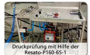
Druckprüfung mit Hilfe der Resato-P160-65-1
